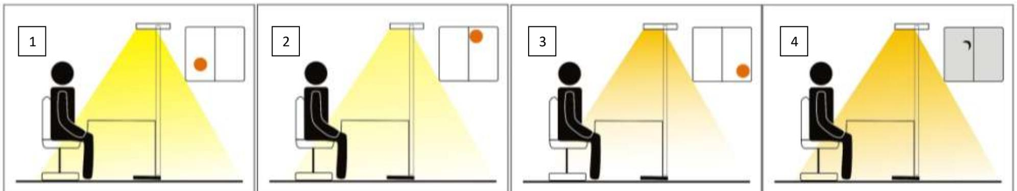
Nach jeder manuellen Einstellung zeichnet die Steuereinheit die Helligkeit auf und speichert diese, bis zum nächsten manuellen dimmen.
